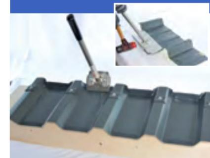
Funktion 2: Abkantung des Profiluntergurtes im Traufenbereich für ein einwandfreies Abtropfen des Wassers in nur einem Arbeitsgang.
